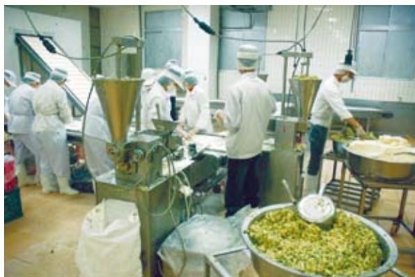
■麵皮、餡料等原料均架高，避免接觸地面遭污染
